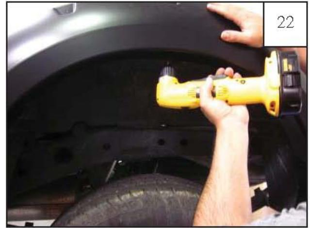
Wie abgebildet ein Bohrloch in den Kotflügel anbringen und die Verbreiterungen mit der mitgelieferten Schraube SW1-0066 befestigen
