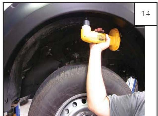
Wie abgebildet ein Bohrloch in den Kotflügel anbringen und die Verbreiterung mit der mitgelieferten Schraube SW1-0066 befestigen
