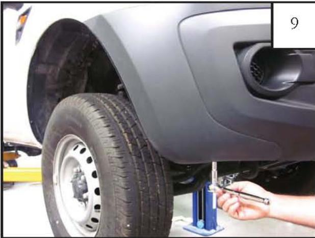
Seirenschraube wie abgebildet demontieren und zusammen mit Pocket Verbreiterung wieder montieren
