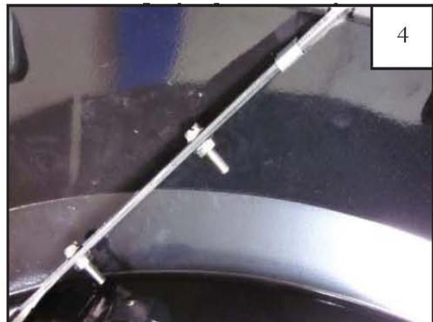
Verbreiterungsteile vorne wie abgebildet am Kotflügel montieren
