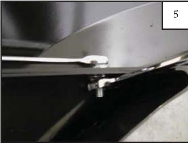
Verbreiterungsteile Kotflügel vorne und Verbreiterungsteile Stoßstange mit mitgelieferten Schrauben NU1 0011 verbinden
