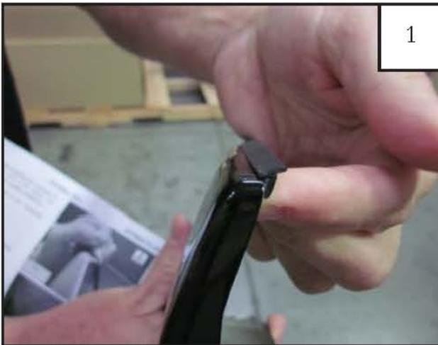
Befestigen Sie wie abgebildet das Kederband an der Anlagefläche zum Kotflügel
