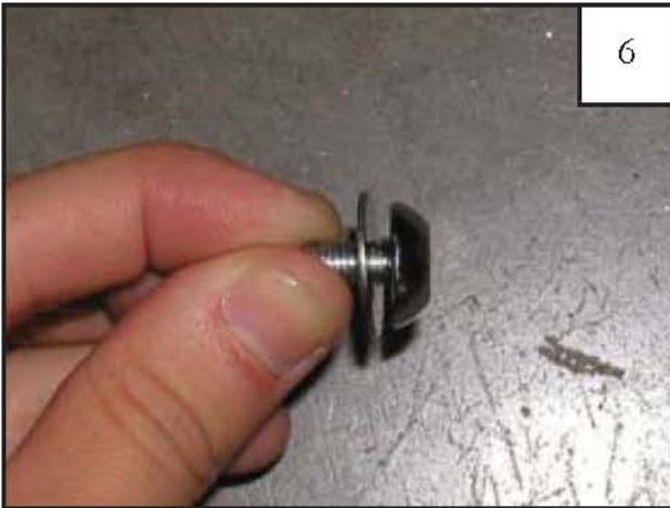
Montieren Sie jetzt die Pocketschrauben wie abgebildet
