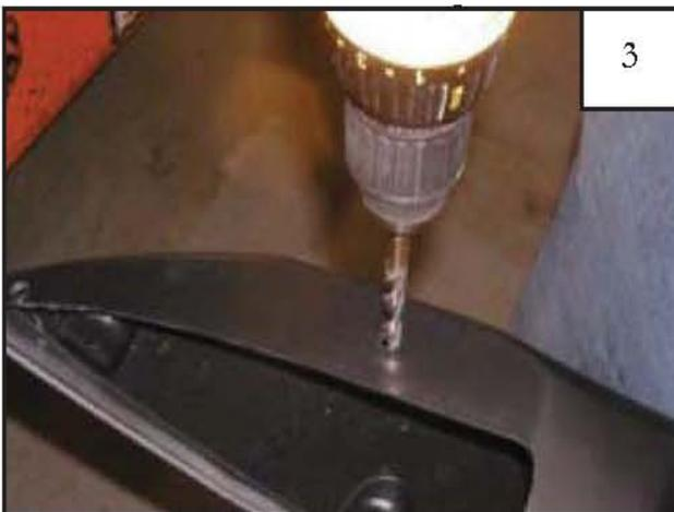
Verbreiterungsteile vorne wie abgebildet am Kotflügel montieren
