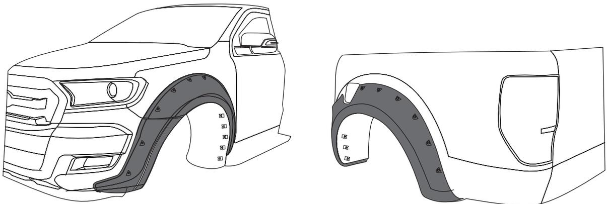
8. Befestigen Sie nun den Kotflügel indem Sie die beiliegenden Schrauben in den Löchern einsetzen und fest anschrauben.
