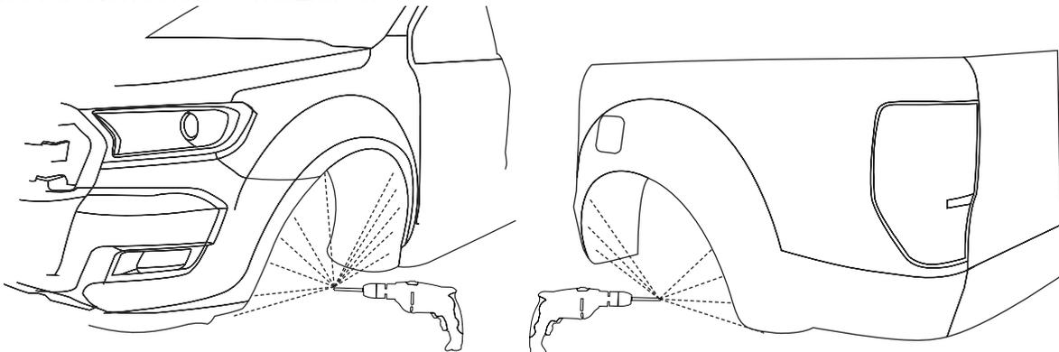
5. Stecken Sie die Klemmen so auf die Kotflügelkante, das die Löcher der Klemme über den Bohrlöchern liegen
